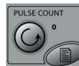
Figura 2-23: Botón de contador y puesta a cero de impulsos
