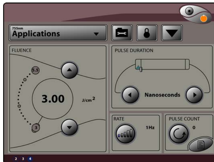
Figura 3-6: Pantalla principal del panel de visualización con pantalla táctil
