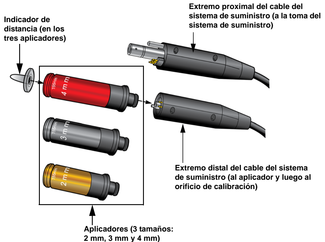
Figura 2-8: Conectores del cable del sistema de suministro, aplicadores e indicador de distancia
